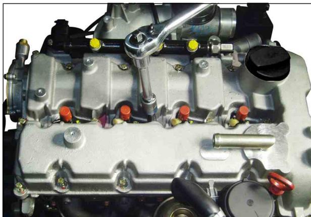
9. Снять герметизирующие заглушки с форсунок и установить новые топливные трубки высокого давления.
