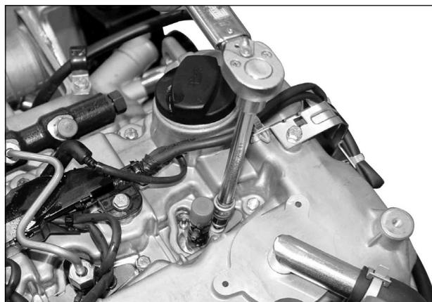
6. Снять форсунки с помощью специального инструмента.
