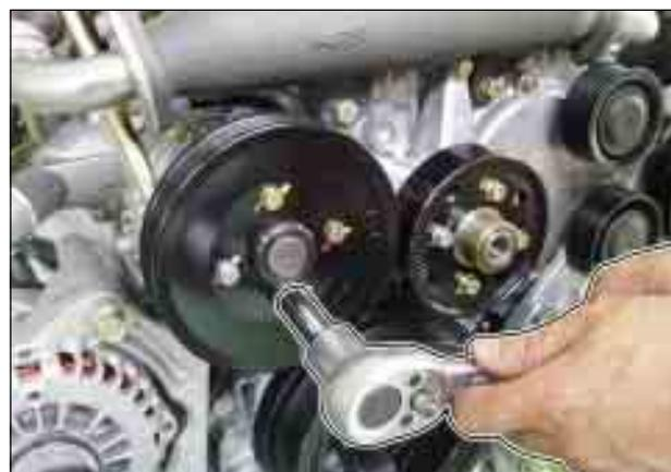
3. Выкрутить нижний 13 мм и верхний 24 мм болты и снять автоматический натяжитель.
