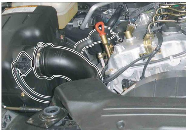
21. Снять выпускную трубку системы EGR и прокладку. Снять центральную трубку (радиатор) системы EGR.
