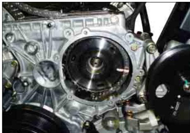
7. Снять датчик положения распредвала.
