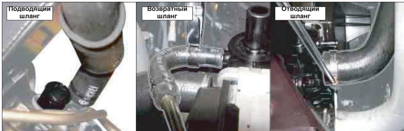
4. Отсоединить шланг системы кондиционирования и трубу конденсатора.
