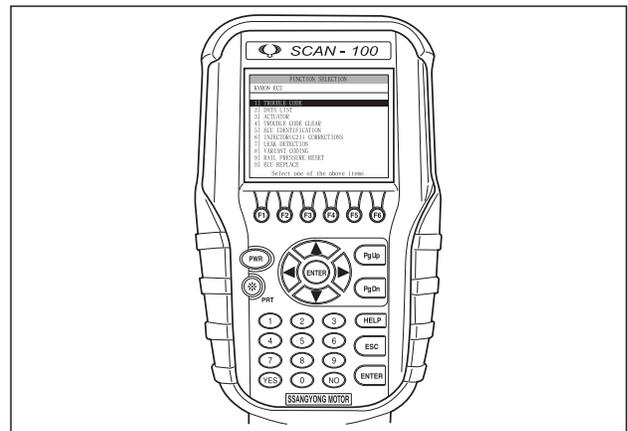
2. На экране сканера появится окно "DIAGNOSTIC TROUBLE CODEs" с кодами неисправностей.
