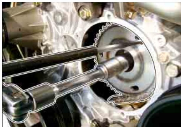
9. Выкрутить крепежные болты ТНВД так, чтобы они вышли за плоскость звездочки ТНВД.
