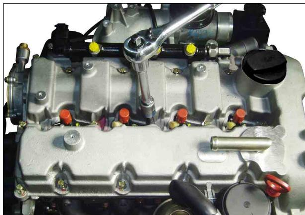
8. Снять герметизирующие заглушки с форсунок и установить новые трубки высокого давления.
