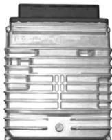
Электронный блок управления / Барометрический датчик
