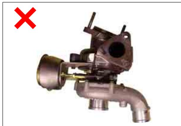
3. Ни в коем случае не пытаться восстановить положение регулировочного винта, помеченного желтой краской, или штока привода. В случае ослабления винта либо штока, их следует заменять вместе, регулировка выполняется заводом-изготовителем.
