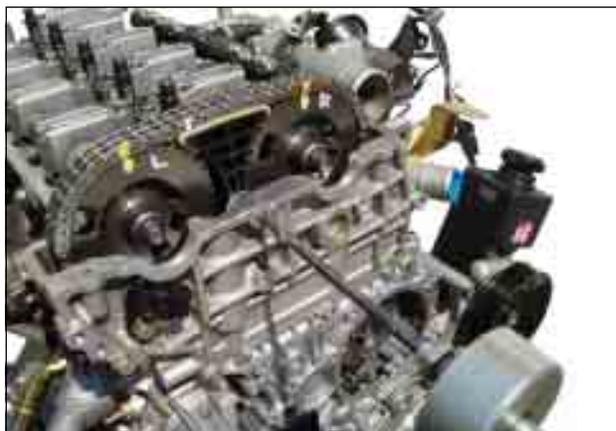
10. Снять радиатор системы смазки и впускной коллектор.
