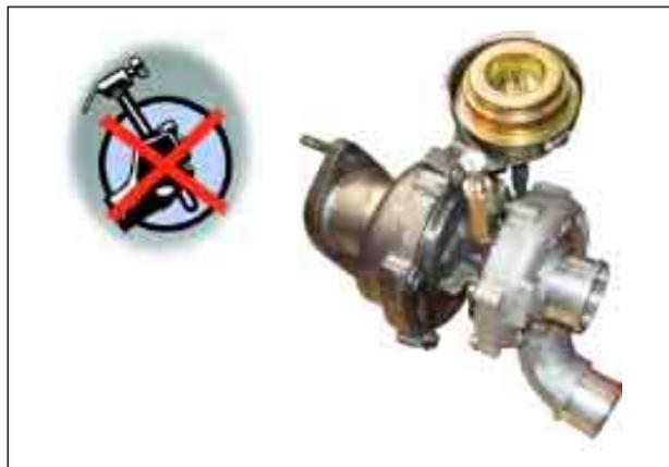
2. Снятый турбонагнетатель должен храниться в горизонтальном положении. При наличии в центральном корпусе турбонагнетателя большого количества масла, если он хранится в вертикальном положении (корпусом турбины вниз), масло может попасть в механизм синхронизатора, что может привести к выходу его из строя.
