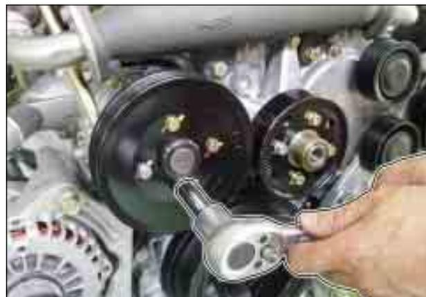
3. Выкрутить нижний (13 мм) и верхний болты (24 мм) и снять автоматический натяжитель.
