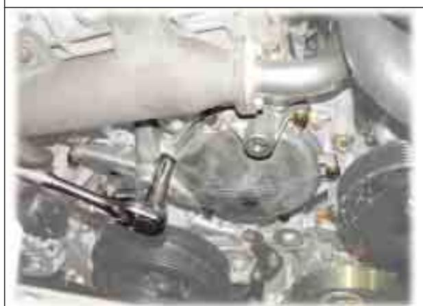
Снять кронштейн (крышку звездочек привода ТНВД)
