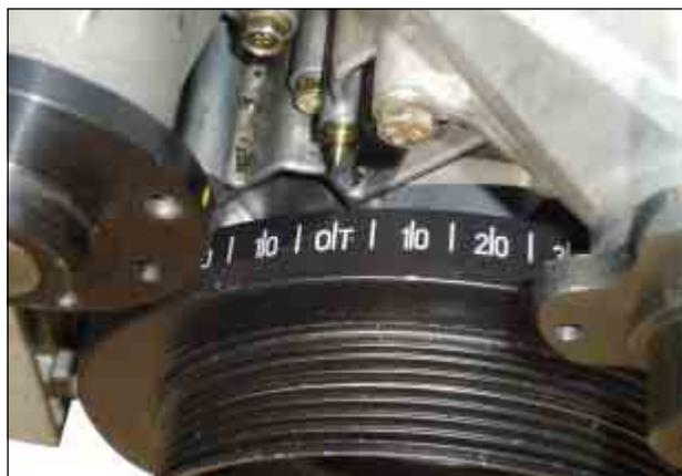
4. Перед снятием нанести метки относительного положения цепи и звездочек привода ГРМ для согласования положения коленвала и распредвала при установке.
