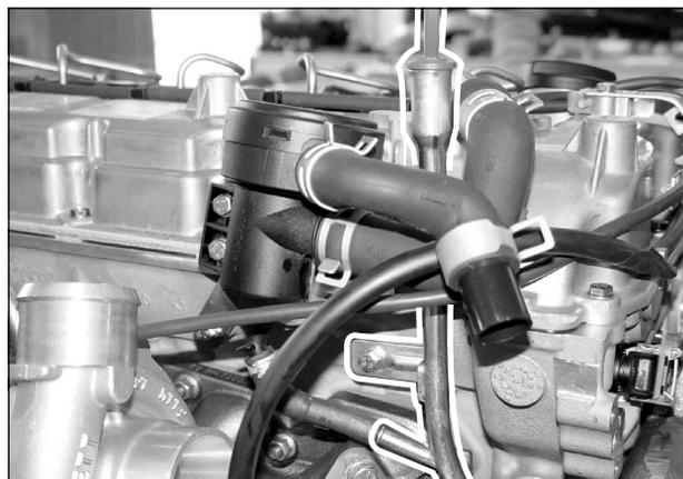
19. Установить трубку маслоизмерительного щупа и держатель трубки.
