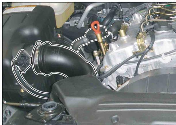
3. Вывернуть болты крепления корпуса воздухоочистителя.
