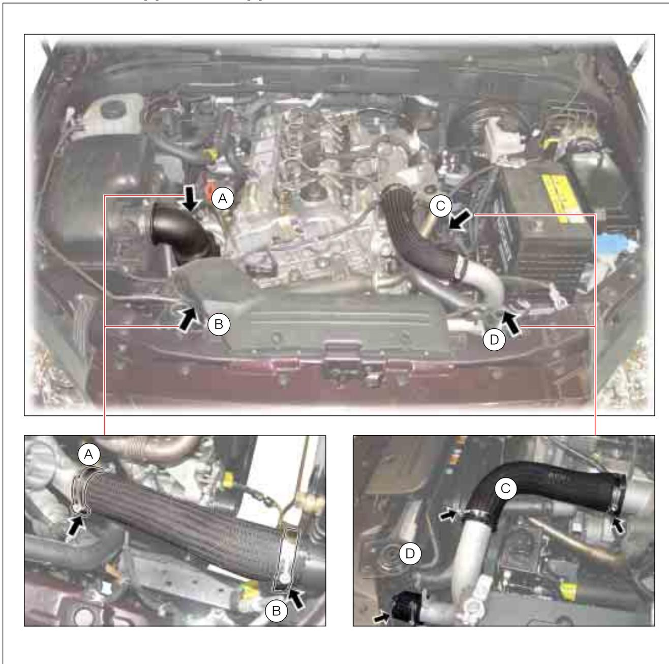
Существует вероятность ослабления хомутов крепления воздухопроводов системы подачи воздуха под действием давления турбонаддува, поэтому их необходимо затягивать с заданным моментом, используя динамометрический ключ с трещоткой.
