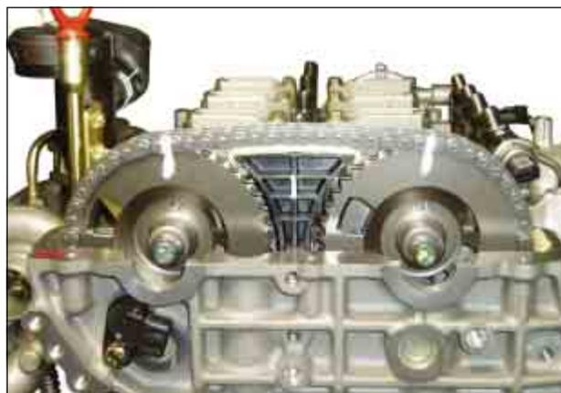
5. Снять натяжитель цепи после снятия патрубка системы EGR и маслоизмерительного щупа.
