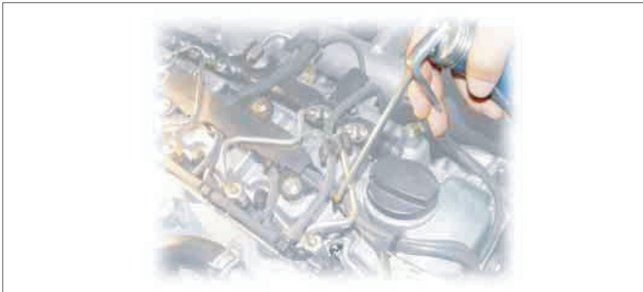
4. Снять свечи накаливания с помощью динамометрического ключа (момент затяжки:  $15 \pm 3$  Нм).
