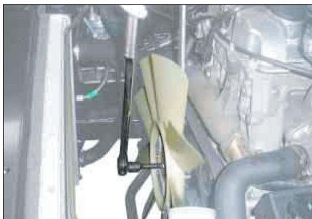
6. Снять кожух.
