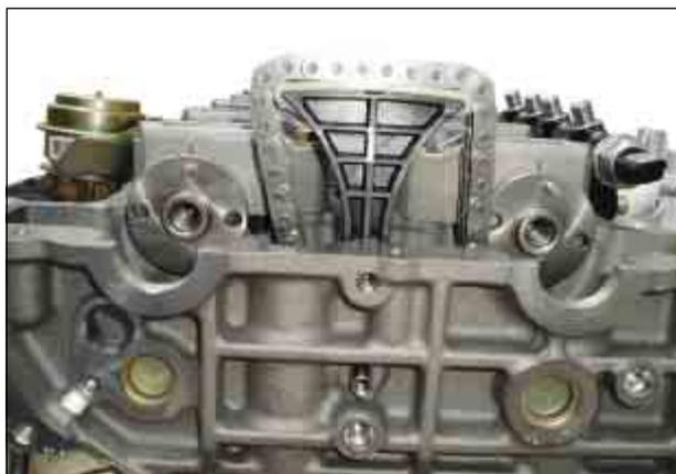
5. Установить звездочки впускного и выпускного распредвалов и цепь привода ГРМ согласно нанесенным ранее меткам.
