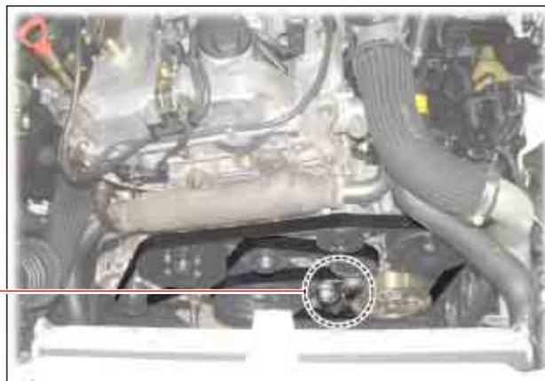
2. Снять автоматический натяжитель с двигателя.
