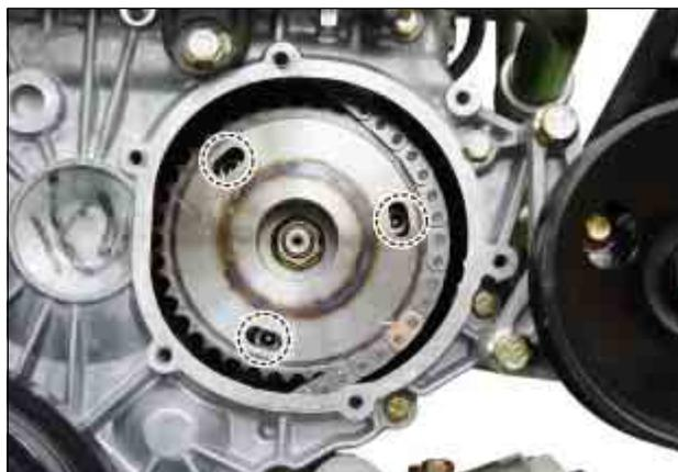
8. Ослабить центральный болт, удерживая звездочку привода ТНВД от проворачивания.
