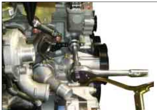
6. Снять ТНВД, предварительно нанеся метки относительного положения звездочки и цепи привода.
