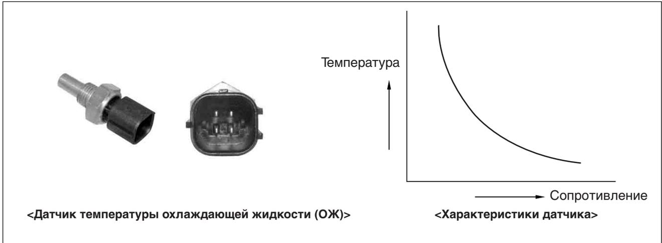
Датчик температуры охлаждающей жидкости (ОЖ) представляет собой резистор с отрицательным температурным коэффициентом (NTC), который передает данные о температуре охлаждающей жидкости блоку управления двигателем (ECU).
