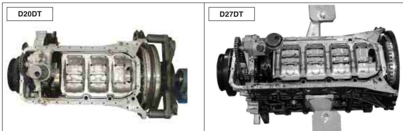
35. Выкрутить болты и снять маслоприемник в сборе.
