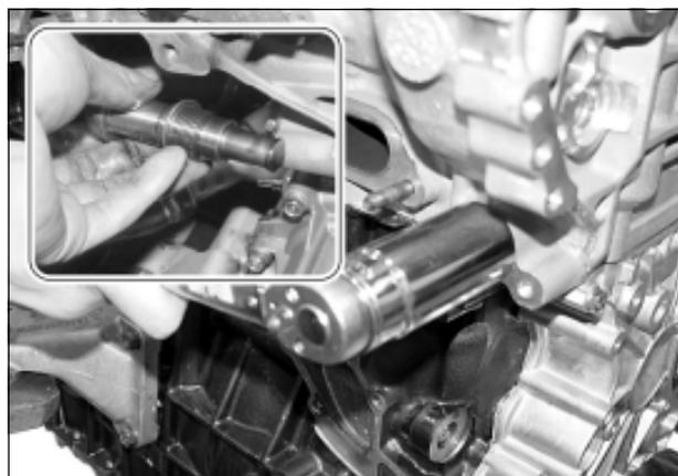
22. Извлечь стопорный штифт и снять верхнюю направляющую цепи.
