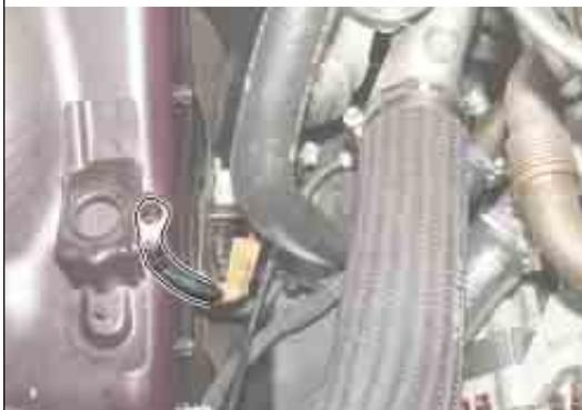
**Жгут проводов генератора**
