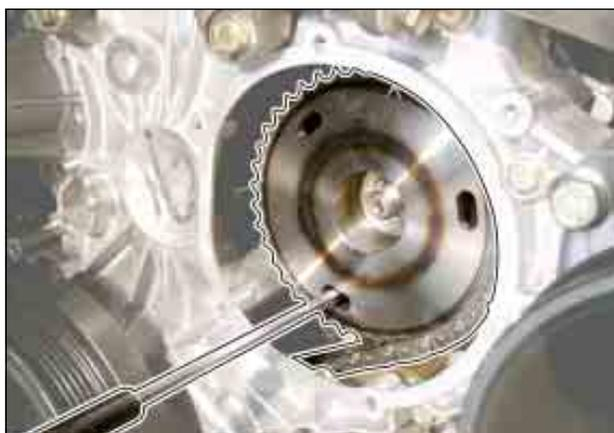
3. Закрутить центральную гайку, удерживая звездочку привода ТНВД от проворачивания.
