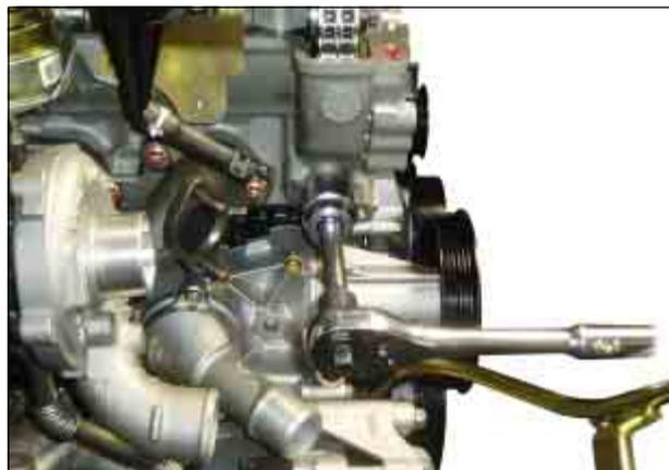
6. Пометить относительное положение звездочки привода ТНВД и цепи, снять звездочку ТНВД.
