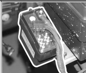
Главный блок реле и предохранителей
