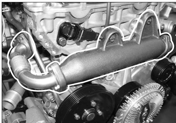
22. Снять скобу крепления маслоизмерительного щупа и трубку маслоизмерительного щупа вместе с уплотнительным кольцом.
