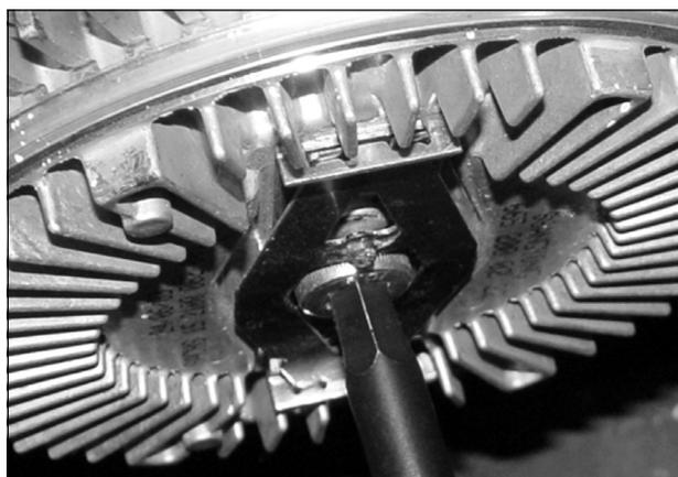
5. Выкрутить болты и снять шкив привода насоса системы охлаждения, удерживая его от проворачивания специальным инструментом.
