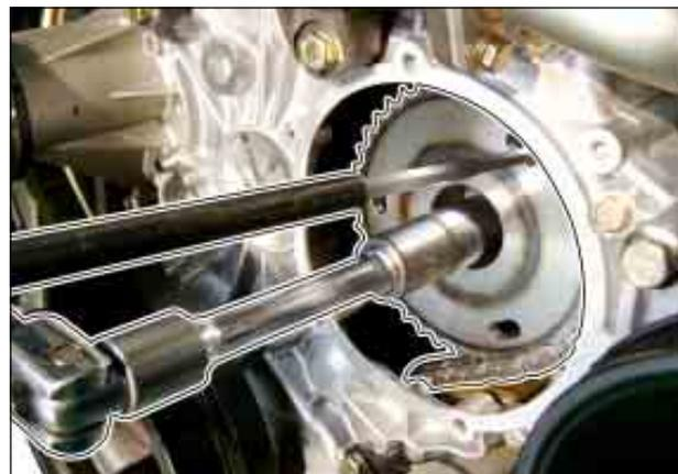
9. Выкрутить крепежные болты ТНВД так, чтобы они выступали над поверхностью звездочки.
