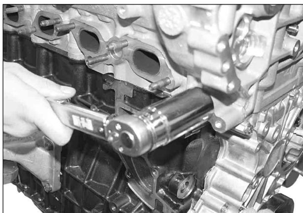
5. Удерживая распредвалы, снять звездочки впускного и выпускного распредвалов.
