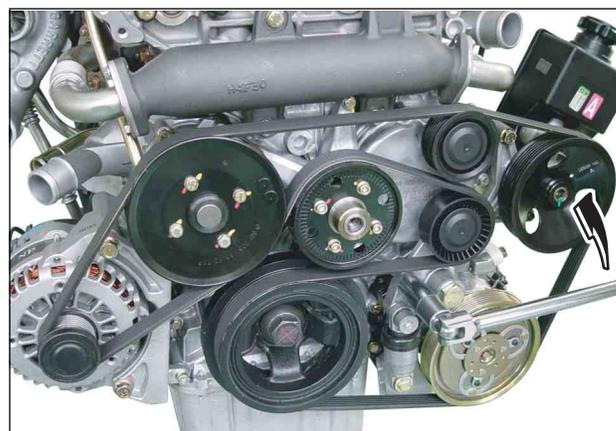
2. Снять шкивы ременного привода.
