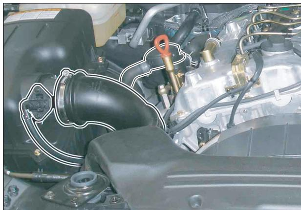
4. Ослабить хомут и отсоединить конец шланга, подводящий жидкость из радиатора в корпус термостата.
