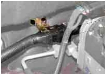
**Подводящий воздуховод интеркулера и шланг подвода охлаждающей жидкости**
