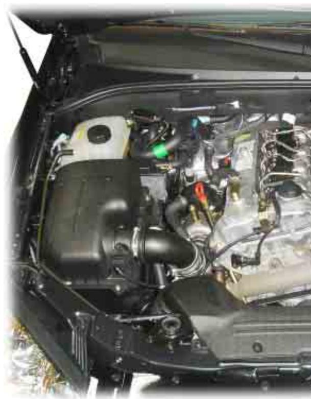
Вакуумный шланг усилителя тормозов и шланг топливного фильтра
