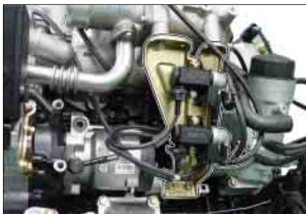
9. Провернуть коленвал по часовой стрелке так, чтобы отверстия звездочки ТНВД были установлены напротив крепежных болтов.
