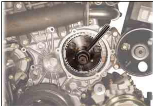
10. Отделить шестерню от ТНВД, выкручивая центральный болт при помощи съемника.
