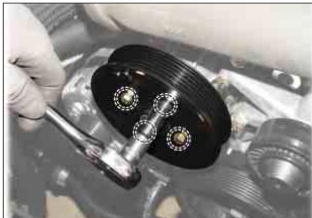
4. Снять колпачки (A, B) и открутить монтажные болты для снятия шкивов (A, B) холостого хода.
