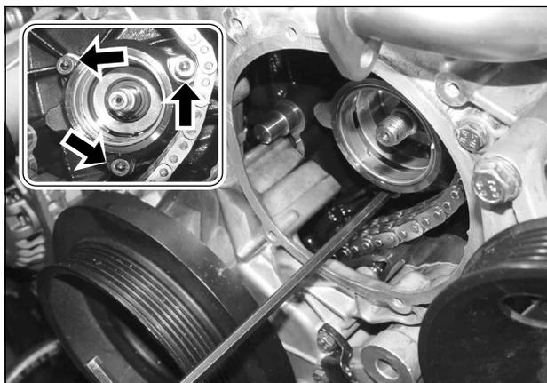
30. Снять опорный кронштейн, расположенный за ТНВД.
