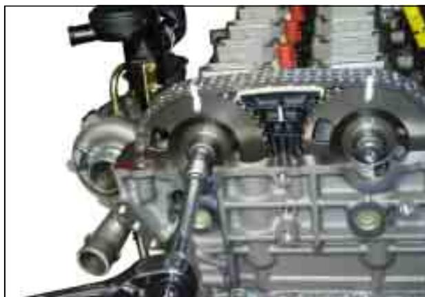
9. Выкрутить болты крепления крышек подшипников распредвалов, отпуская их поочередно, для равномерного распределения давления на крышки.
