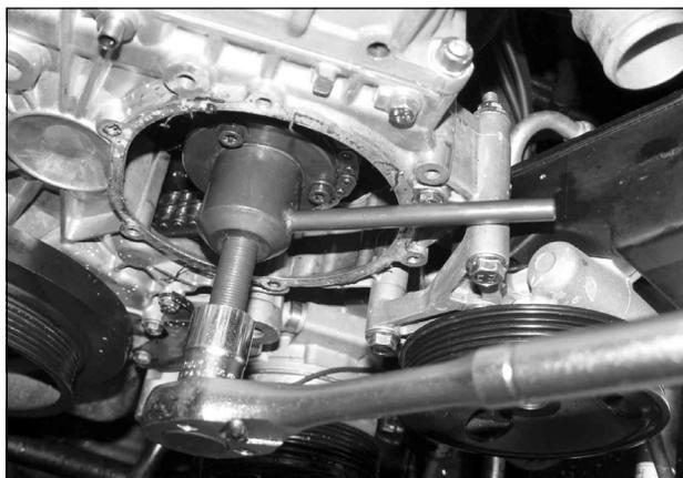
29. Снять кронштейн подшипника ТНВД.
