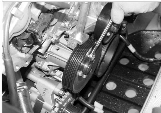
18. Установить муфту вентилятора системы охлаждения с помощью специального инструмента.
