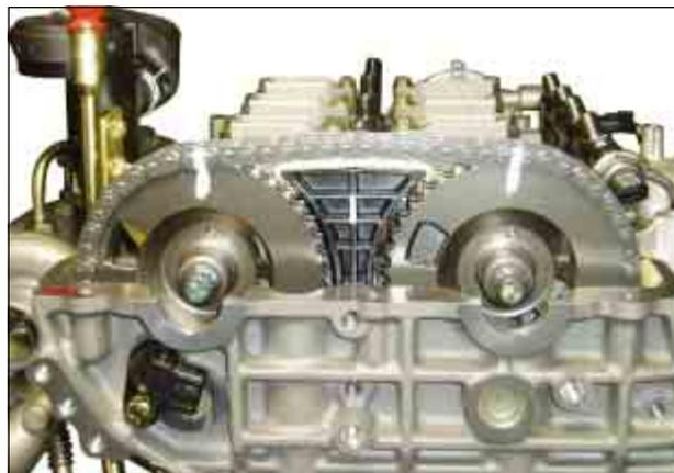
5. Снять натяжитель цепи после снятия трубки системы рециркуляции отработавших газов (EGR) и маслоизмерительного щупа.
