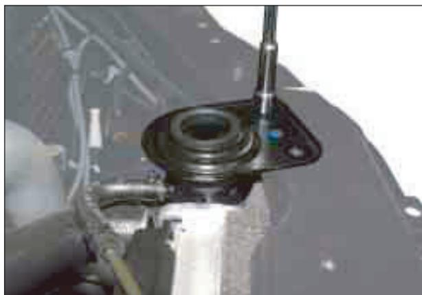
6. Отсоединить трубки масляного радиатора.
