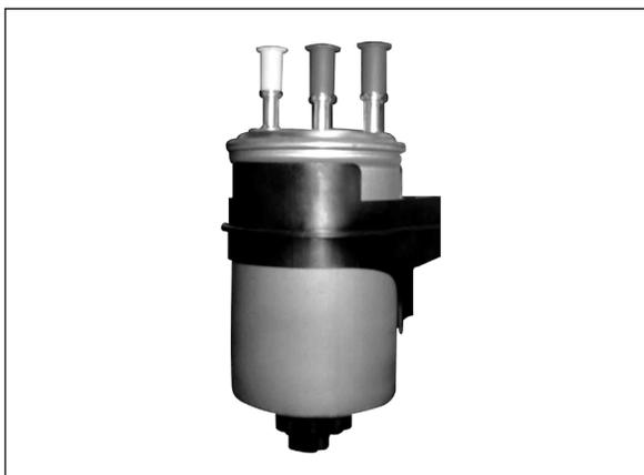
Если вода в отстойнике превысит определенный уровень, она попадет в ТНВД вместе с топливом. Для предотвращения превышения максимально допустимого уровня, сработает соответствующий датчик и блок управления двигателем активирует предупреждающие звуковой и световой (
