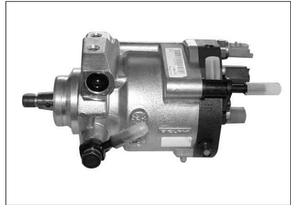
9. Заполнить ТНВД топливом, прокачивая его топливоподкачивающим насосом до появления значительного сопротивления в тракте.
