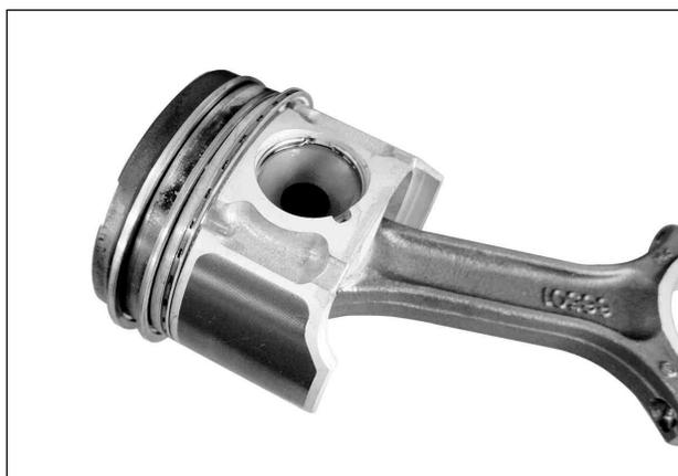
7. Смазать внутреннюю поверхность цилиндра, вкладыши шатунных подшипников и поршни моторным маслом.
