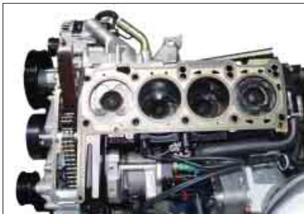
13. Измерить выступание поршня над поверхностью блока цилиндров.
