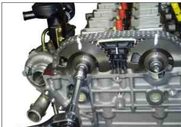
9. Снять ось крепления верхней направляющей с помощью обратного молотка.
