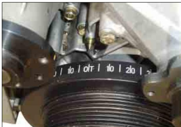
4. Перед снятием звездочки поместить цепь привода, звездочку впускного распредвала и звездочку выпускного распредвала для дальнейшей правильной установки фаз газораспределения.
