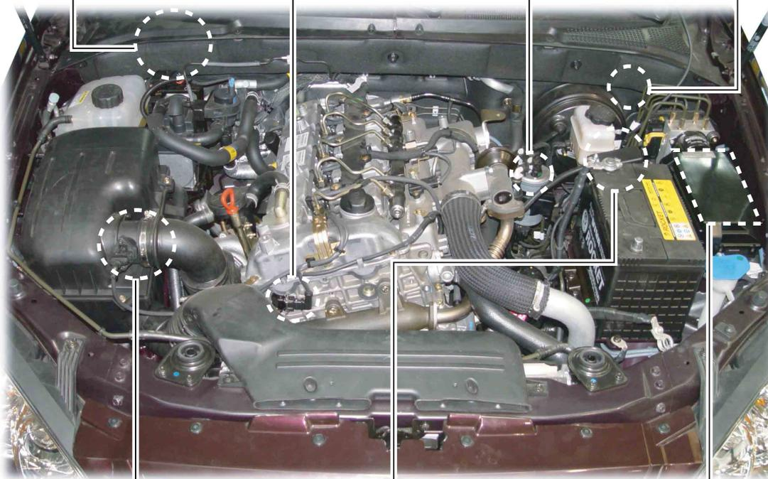
Термоанемометрический расходомер воздуха (HFM) / Датчик температуры воздуха на впуске
