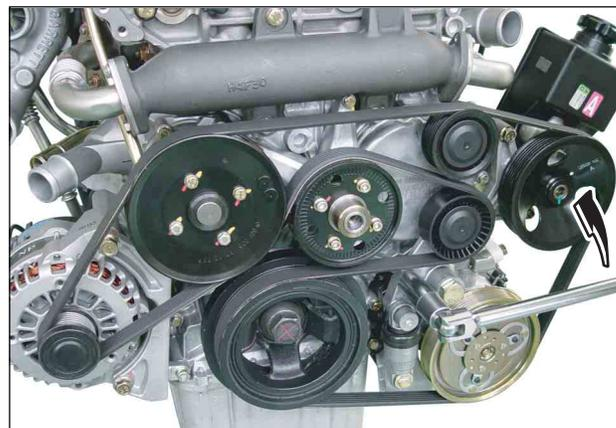
2. Снять шкивы ременного привода.
