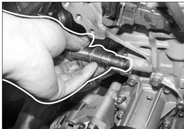
24. Пометить относительное положение звездочки ТНВД и цепи привода ГРМ.
