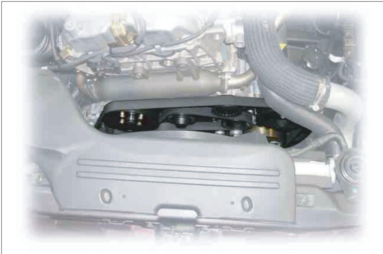
1. Установить ключ на регулировочный болт (19 мм) и отжать автоматический натяжитель ремня по направлению против часовой стрелки .
