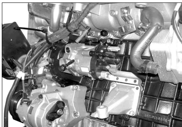
7. Провернуть шкив коленчатого вала в направлении против часовой стрелки на  $45^\circ$  (после ВМТ), а затем снять натяжитель цепи.
