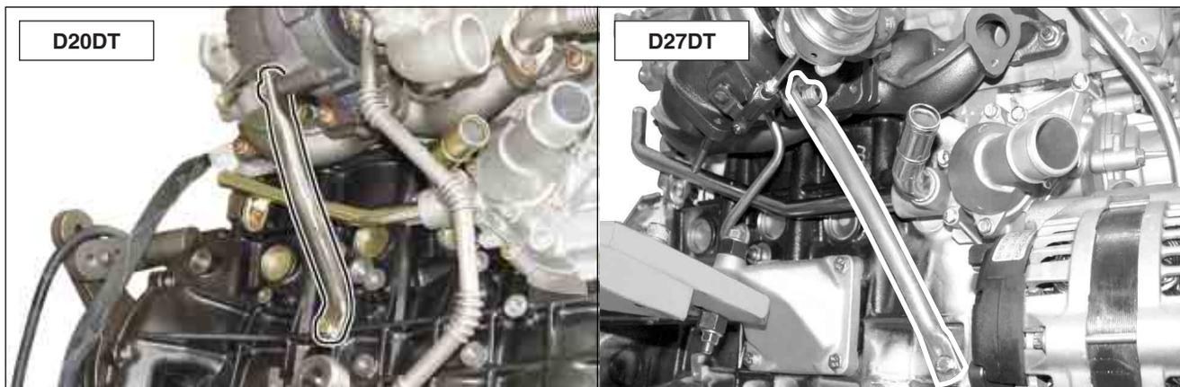
8. Выкрутить болты и отпустить гайки крепления турбонагнетателя к выпускному коллектору.
