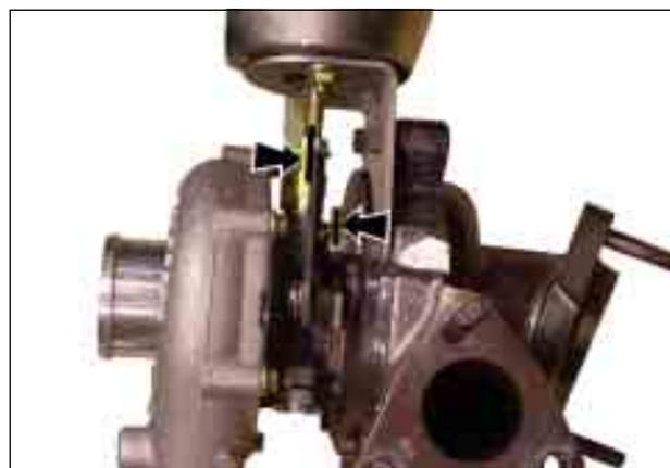
5. После установки турбоагнетателя на двигатель, до присоединения трубки подвода масла, залить в центральный корпус небольшое количество чистого моторного масла через отверстие масляного канала.
