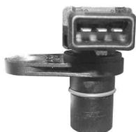
Топливный фильтр (Датчик наличия воды)
