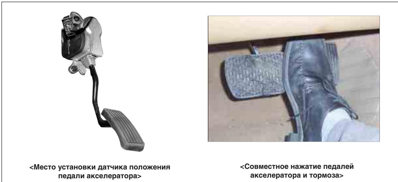
Датчик положения педали акселератора преобразует изменения положения педали в электрический сигнал и передает его на ECU как параметры, задаваемые водителем. В датчике положения педали акселератора объединены 2 сенсора. Сенсор № 1 (ACC 1) определяет требуемый объем впрыскиваемого топлива и момент начала впрыска во время движения, а сигнал сенсора № 2 (ACC 2) используется для подтверждения правильности сигнала первого сенсора.
