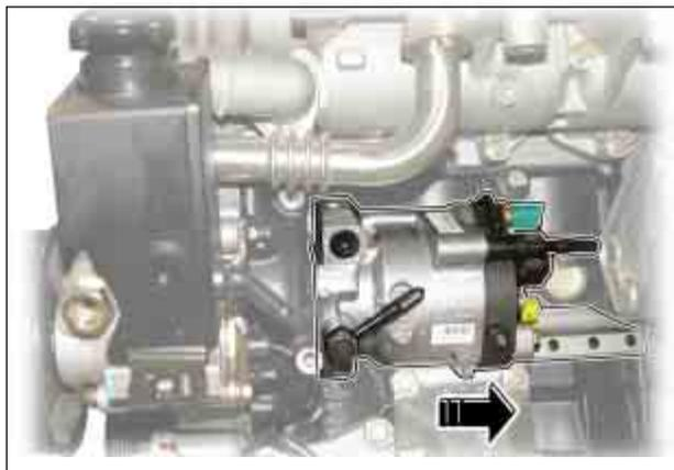
11. Снять съемник, выкрутить три крепежных болта и снять ТНВД.
