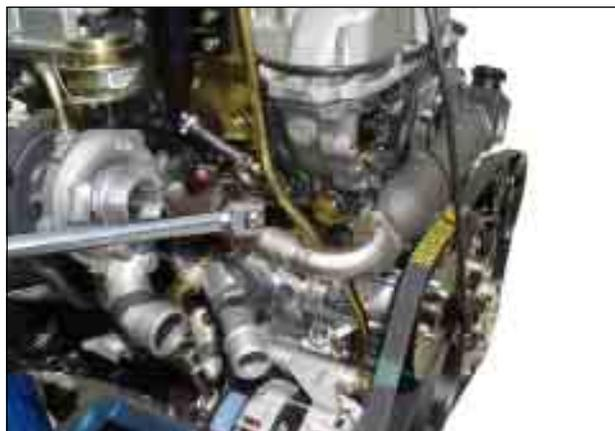
2. Отсоединить топливные линии, разъемы форсунок и крышки гнезда свечей накаливания. Снять крышку головки блока цилиндров.
