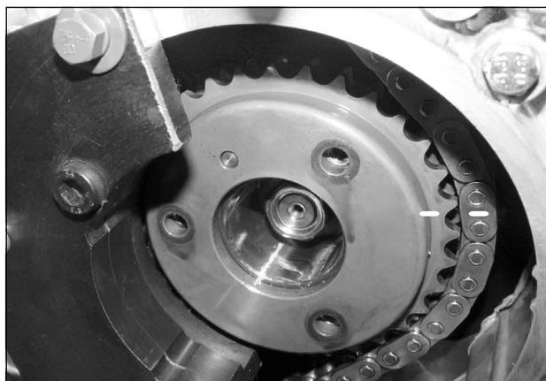
7. Полностью затянуть центральную гайку вала ТНВД.
