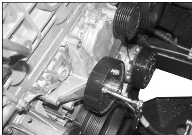
8. Открутить болты и снять кронштейн шкива вентилятора системы охлаждения (с крышки привода ГРМ).
