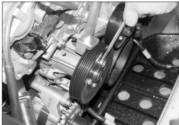
6. Выкрутить верхний и нижний болты и снять автоматический натяжитель.
