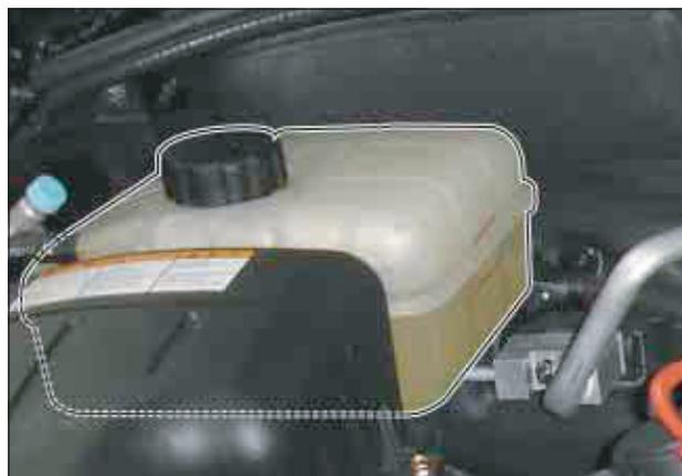
2. Долить охлаждающую жидкость до верхней метки расширительного бачка (указано стрелкой).
