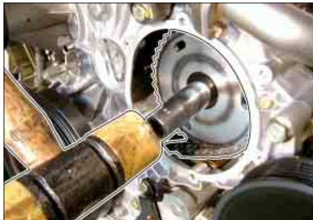
11. Таким же образом выкрутить оставшиеся болты и снять ТНВД.
