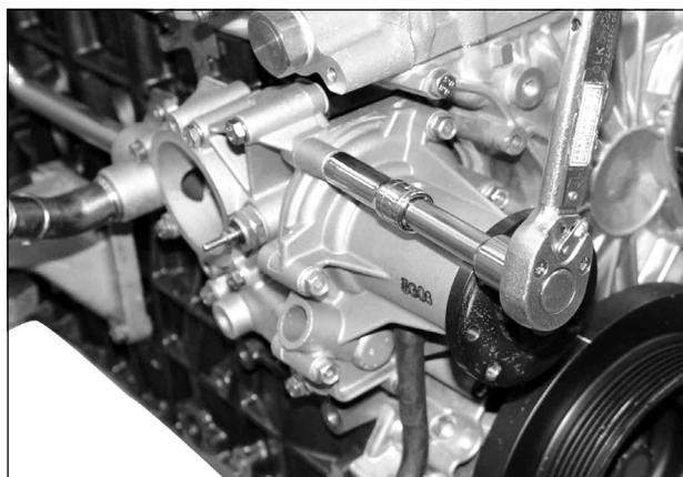
16. Выкрутить болты и снять корпус насоса системы охлаждения.
