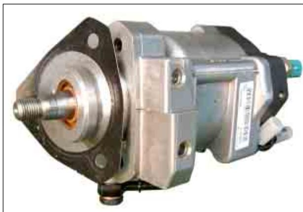
2. Затянуть болты ТНВД от проворачивания.
