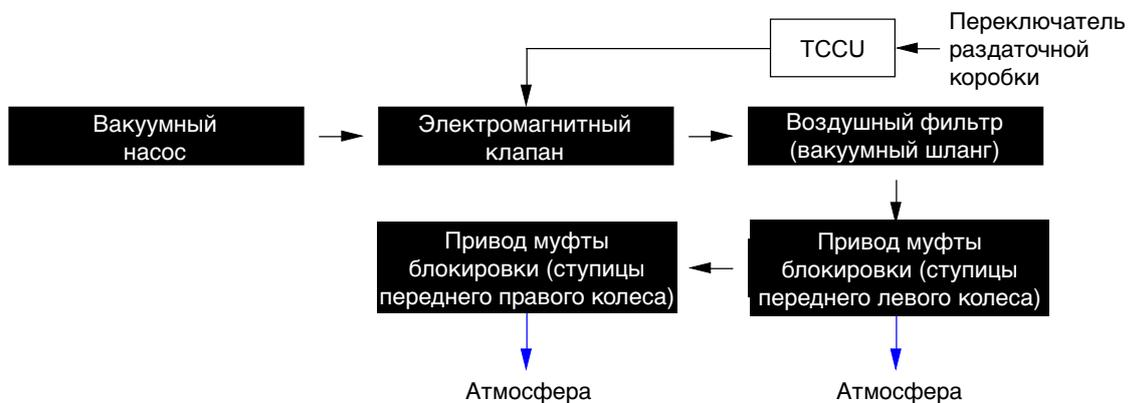
**РАЗДАТОЧНАЯ КОРОБКА С РУЧНЫМ УПРАВЛЕНИЕМ ("PART TIME") И СИСТЕМОЙ МУФТ БЛОКИРОВКИ СТУПИЦ**
